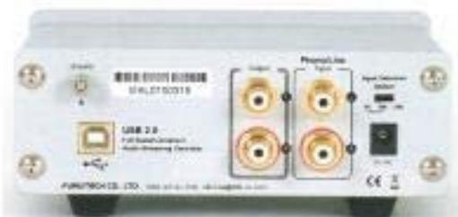
右側が入力端子で、右端にある3ポジションのスライドスイッチでMC、MM、ラインに切り換える。左はUSB入力
