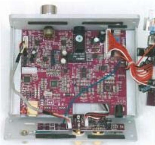
肉厚のアルミ筐体に高密度実装のプリント基板を内蔵。A/DおよびD/A、USBインターフェース、ヘッドフォンアンプを1枚の基板に実装。フォノEQはリアパネルにコンパクトにまとめられている
