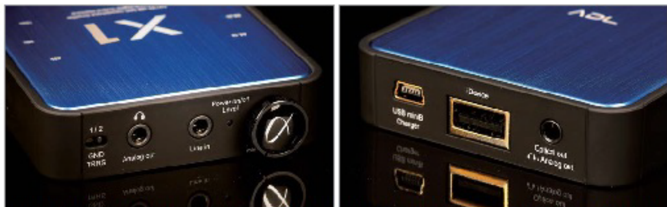
▲左：X1的耳機插孔可以適用OMTP與CTIA標準的TRRS端子耳機，可避免端子規格不同影響聽感。右：Mini B Type USB除了充電與PC數位流播放外，透過USB On-The-Go轉接線可以與Android手機連接，播放純在其內的數位音檔。
