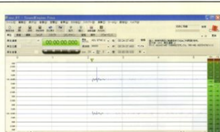
「Sound Engine Play」画面。録音終了後、再生タブをクリックすると再生が始まる。真ん中あたりに針を落としたときのノイズがある、その右側はサーフェースノイズなので、この部分を選択して削除すればノイズはなくなる。
